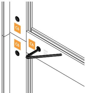
Pour assembler une traverse et un profilé ou 2 profilés ensemble, utiliser la clé Allen et faites un quart de tour.
